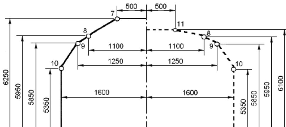
Рисунок В.2 - Минимальное очертание верхней части сооружений при напряжении в контактной сети (1,5-4) кВ
