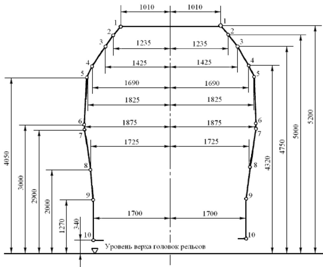
Рисунок 2 - Статический габарит  $T_{ц}$
