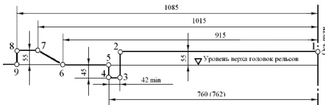
Рисунок 27 - Нижнее очертание габаритов  $C$  и  $C_{II}$  д
