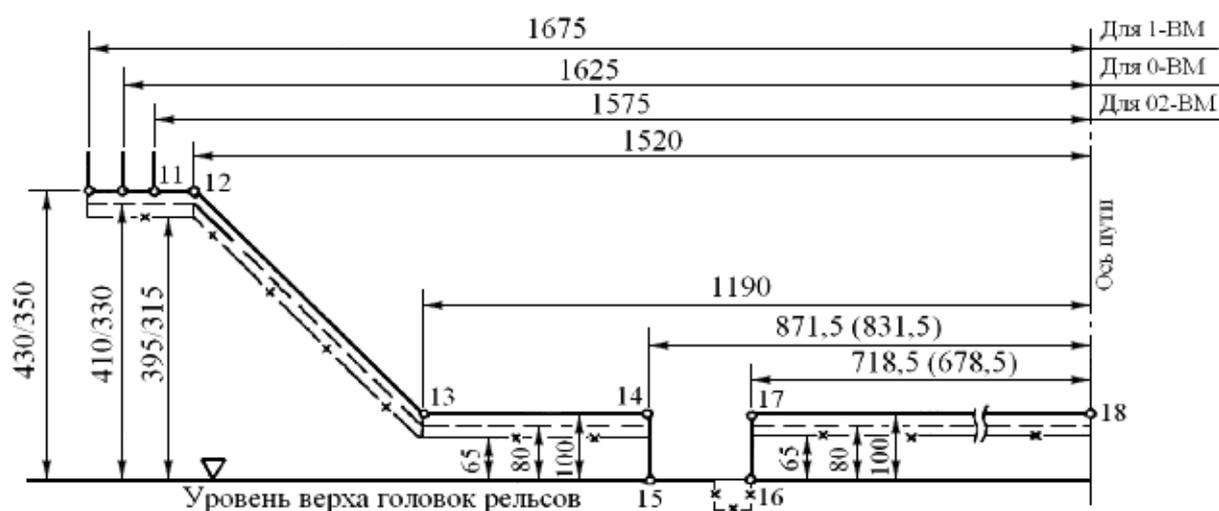
Размеры дробью: в числителе - для железнодорожного подвижного состава, предназначенного для международных сообщений; в знаменателе - только для железных дорог колеи 1520 мм.
