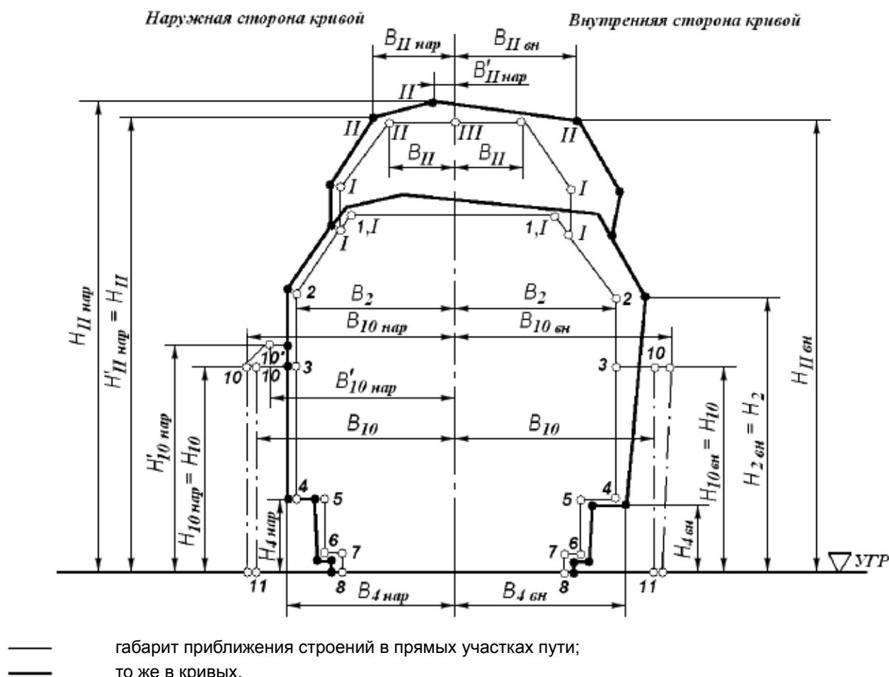
Рисунок Е.1 - Принцип построения габарита приближения строений в кривых по проектным нормам
