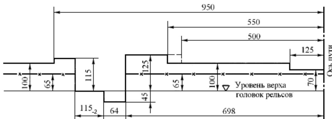
———— очертание, за пределы которого не должна выступать ни одна из частей подвагонного толкателя и других устройств для надвига вагонов в нерабочем положении при установке их на путях, по которым разрешается пропуск только грузовых вагонов;
