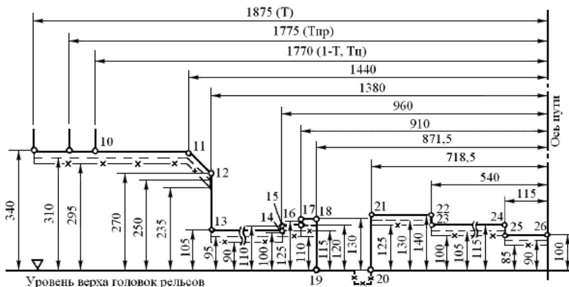
Рисунок 7 - Нижнее очертание габаритов для подвижного состава, проходящего по сортировочным горкам, оборудованным вагонными замедлителями при любом их положении
