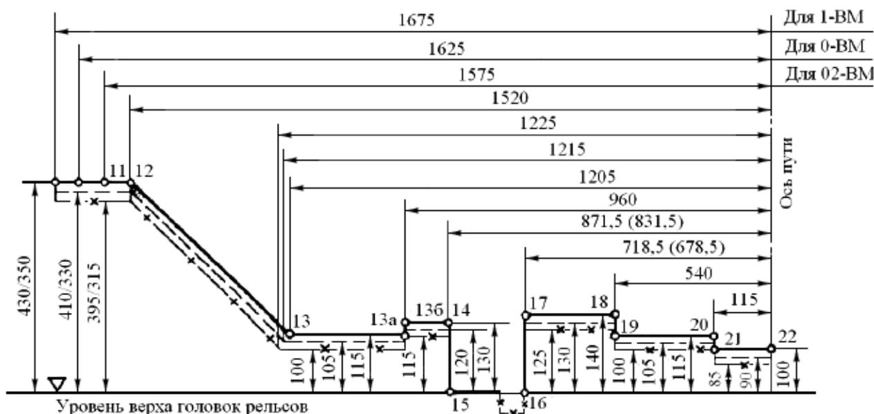
Рисунок 18 - Нижнее очертание габаритов для подвижного состава, проходящего по сортировочным горкам, оборудованным вагонными замедлителями при любом их положении, включая пути сортировочных горок
