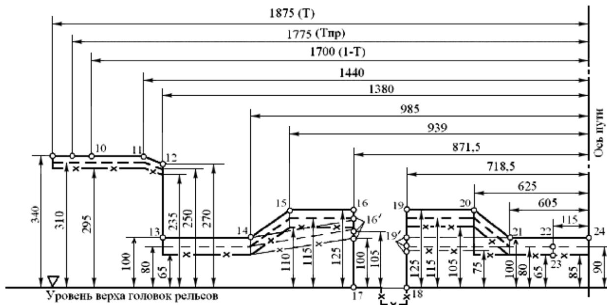
Рисунок 6 - Нижнее очертание габаритов для подвижного состава, проходящего по сортировочным горкам, оборудованным вагонными замедлителями при нерабочем (отторможенном) их положении
