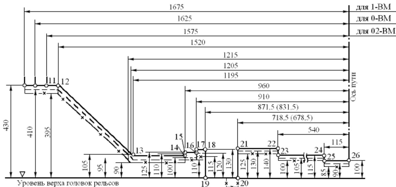
Рисунок 17 - Нижнее очертание габаритов для подвижного состава, проходящего по сортировочным горкам, оборудованным вагонными замедлителями при любом их положении (включая пути сортировочных горок железных дорог государств-участников СНГ)
