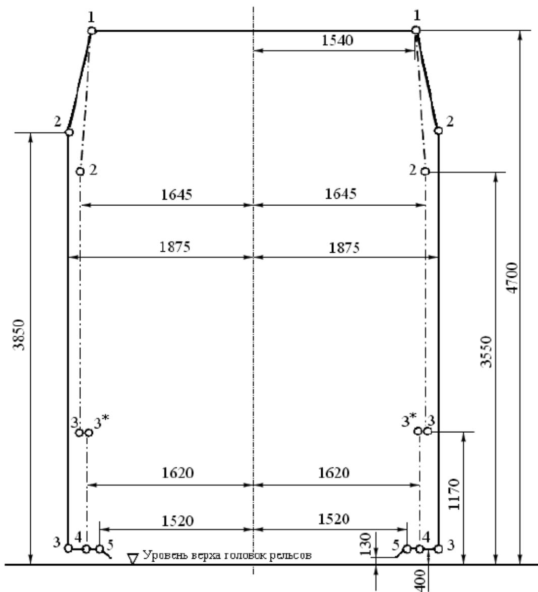
Рисунок 9 - Габарит подвижного состава  $ГЦ(GC)$  и гармонизированный с ним габарит  $ГЦ_{нл}(GC_{нл})$
