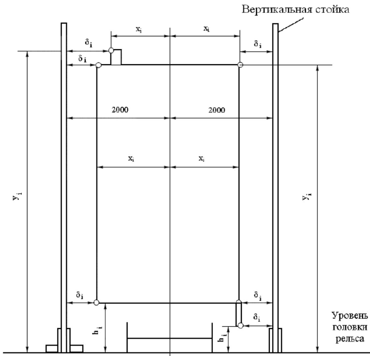
Рисунок И.1 - Схема измерения габаритных размеров
