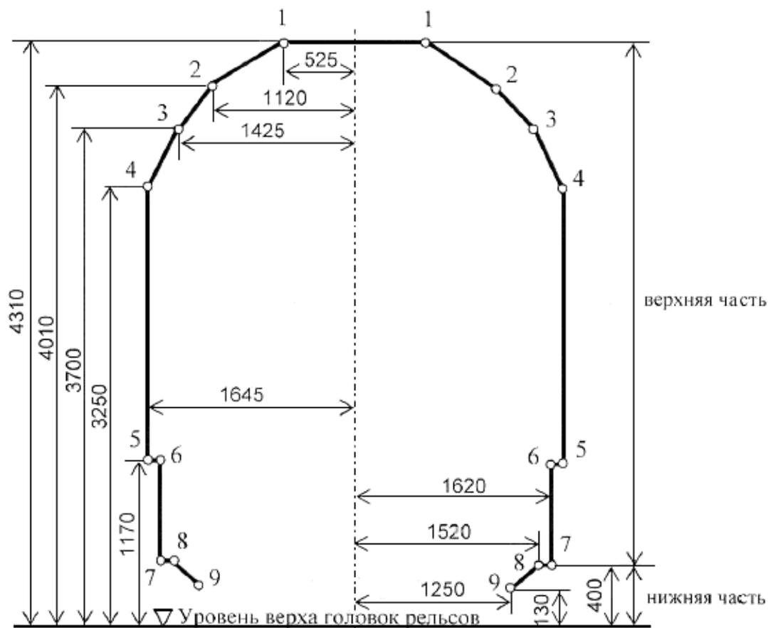
Рисунок 14 - Кинематический габарит 03 –  $BM_k$
